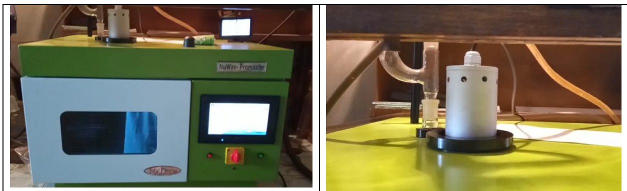
А Б А - микроволновая печь NuWav; Б - погружной ультразвуковой зонд Рисунок2 – Аппаратное оформление микроволнового синтеза
